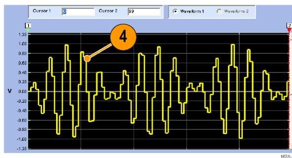
5. Сохраните форму сигнала в формате TFW. Скопируйте параметры сигнала в USB-память и загрузите форму сигнала в генератор сигналов произвольной формы.
